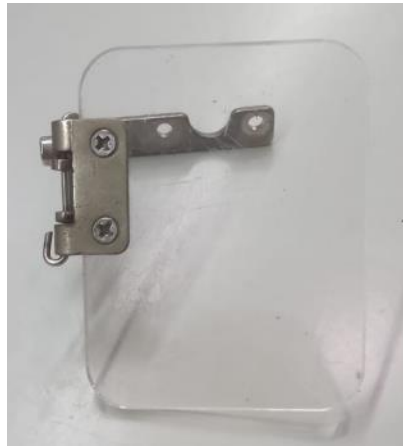
Gambar 2. Pelindung mata mesin jahit
