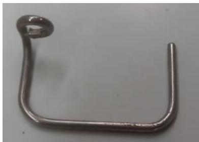
Gambar 1. Pelindung jari mesin jahit
