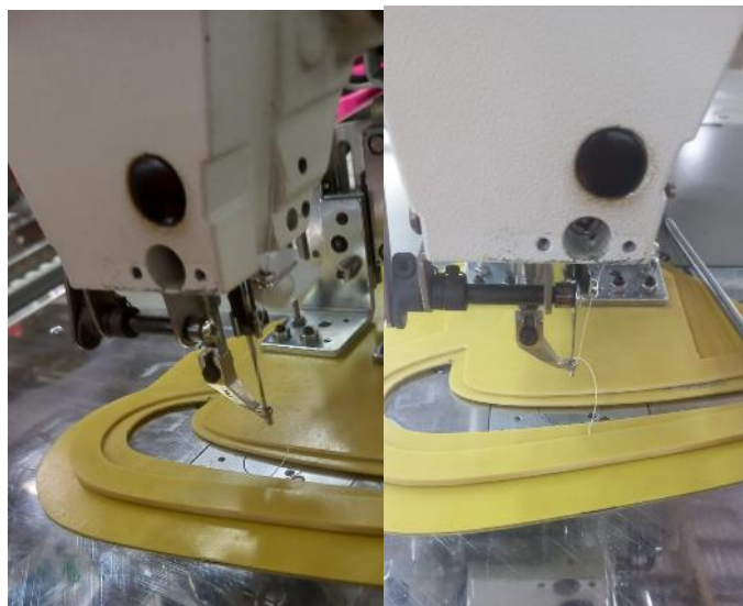
Gambar 3. Mesin jahit komputer sebelum dipasang finger guard /pelindung jari
