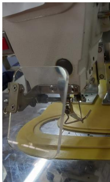
Gambar 5. Mesin jahit komputer sesudah dipasang pelindung jari dan pelindung mata
