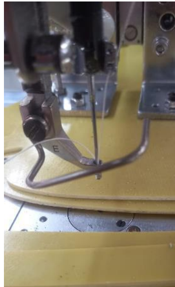
Gambar 4. Mesin jahit komputer sesudah dipasang finger guard /pelindung jari
